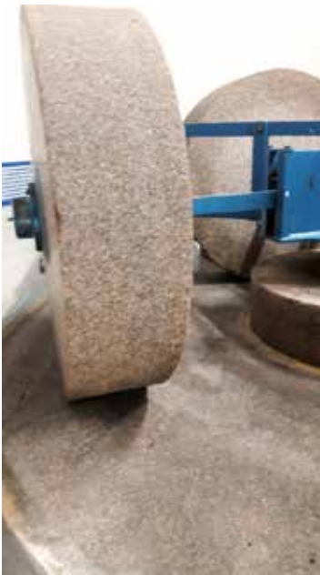
Ölmühle zum Zerkleinern der Oliven
